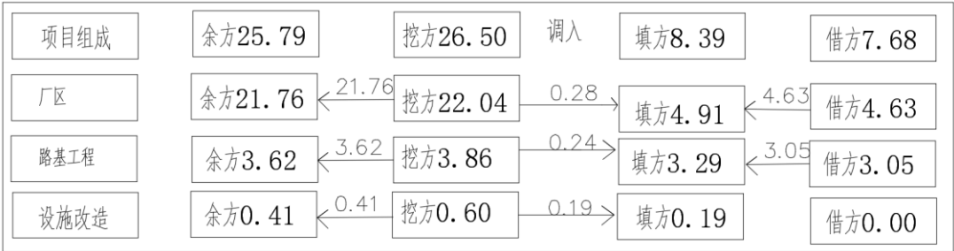
图 2.12 主设土石方平衡流向框图（图中单位均为万 m 3 ）
