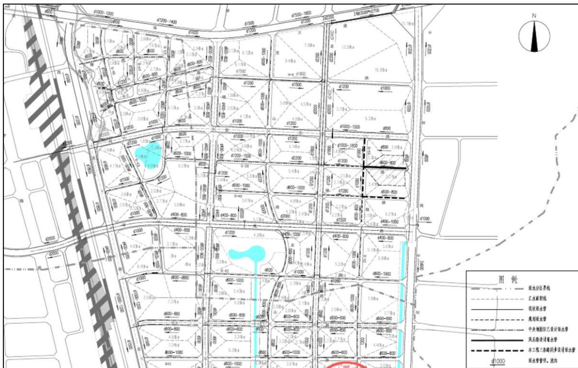
图 2.18 雨水系统图
