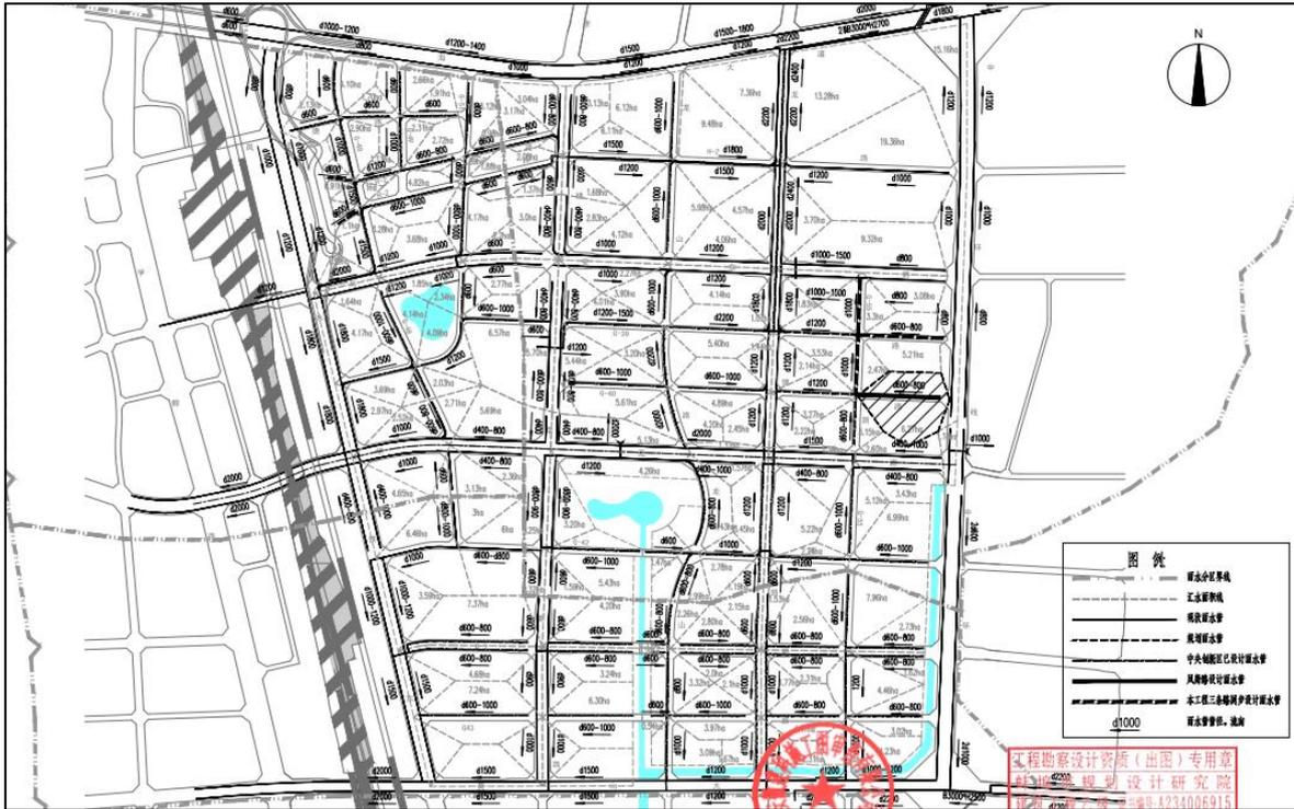
图 2.27 雨水系统图
