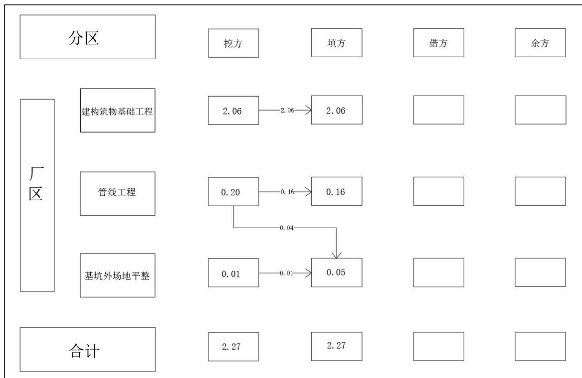
图 1.5-1 土石方平衡 单位: 万 m<sup>3</sup>
