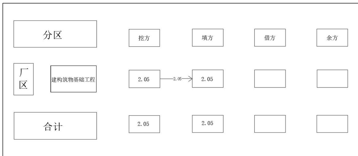
图 1.5-2 已实施土石方平衡 单位：万  $m^3$
