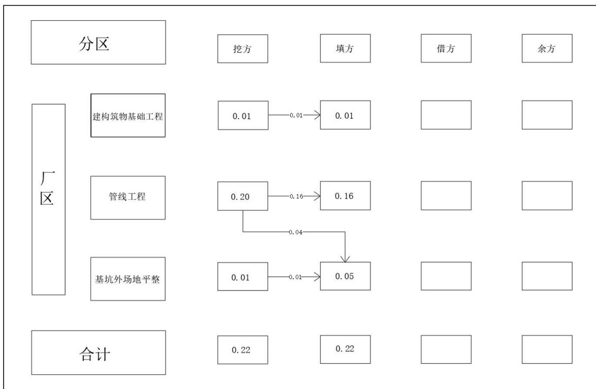
图 1.5-3 待实施土石方平衡 单位：万 m<sup>3</sup>
