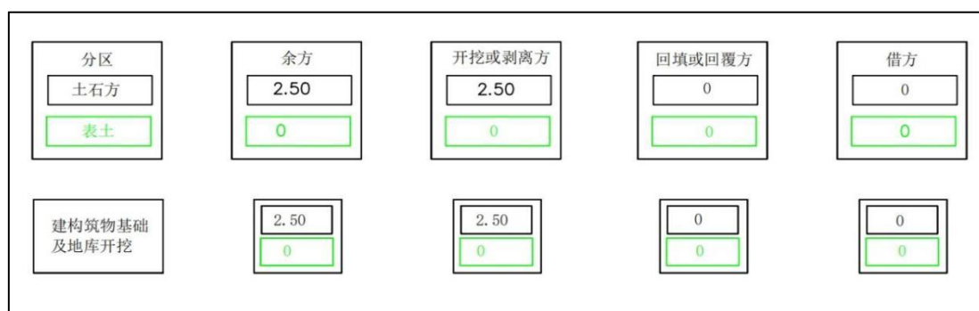
图 1.5-2 已完成土石方平衡框图
