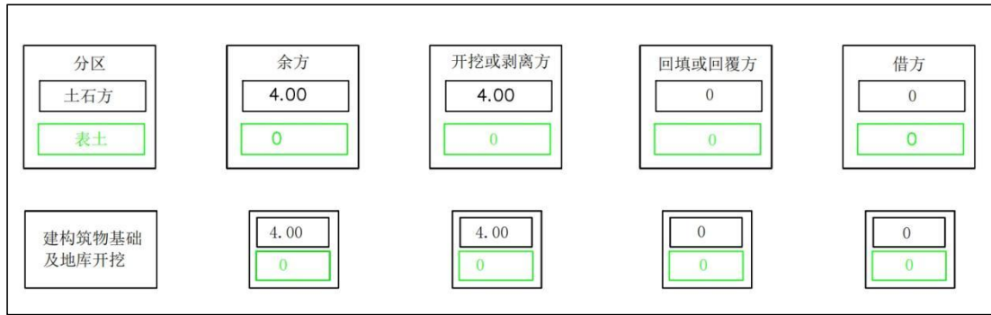
图 2.4-2 已完成土石方平衡流向框图
